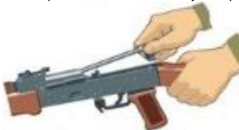
Рисунок 8 – від'єднання поворотального механізму.
