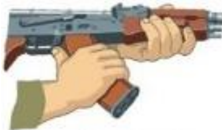
Рисунок 4 – від'єднання магазину автомата Калашнікова.
