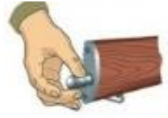
Рисунок 12 – вкладання пеналу належності до гнізда прикладу.
